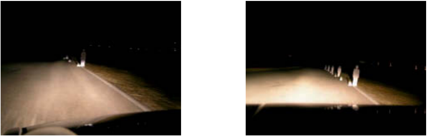
Figura 11: En la imagen de la izquierda se muestra un alumbrado convencional y en la imagen de la derecha un sistema de alumbrado de xenon.
