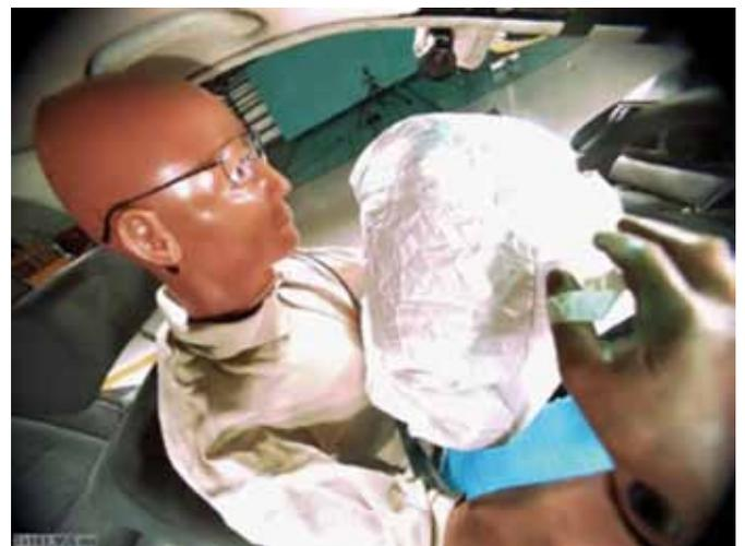
En el rebote y desplazamiento hacia atrás se puede observar como las gafas tienden a levantarse. No se ha registrado ninguna fuerza de compresión significativa sobre el globo ocular. Los cristales permanecen sin roturas, y la montura no muestra daños.
