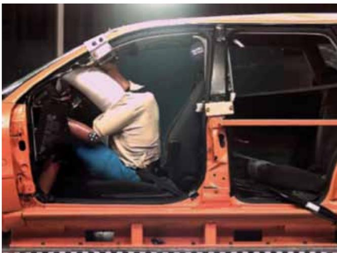
La máxima intrusión de la cabeza contra el airbag y el volante se produce en el msg. 81. La mayor fuerza que se pueda ejercer sobre el globo ocular ocurre hasta dicho instante. A partir de él comienza la separación de la cabeza. A la vista de los datos obtenidos por la cabeza FOCUS, las gafas y los cristales no han ejercido una presión significativa sobre el globo ocular.
