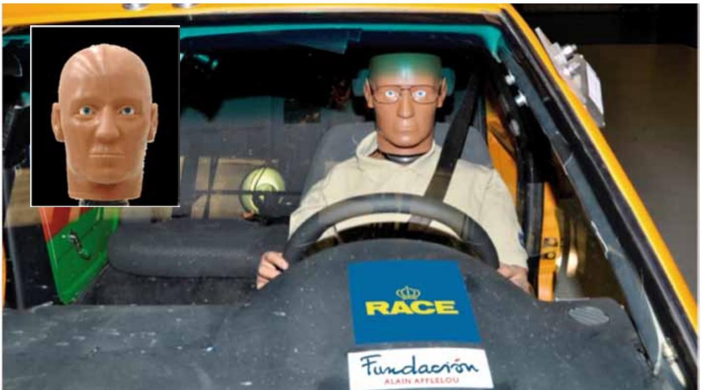
Imagen de la cabeza FOCUS y ojos instrumentados. Imagen previa del test con la cabeza FOCUS
